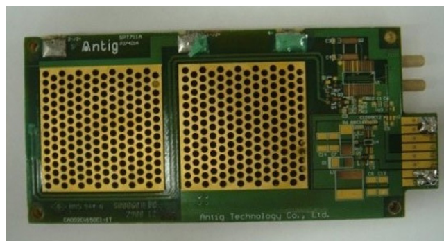
Fig. 2. A planar-type PCB-DMFC module.
